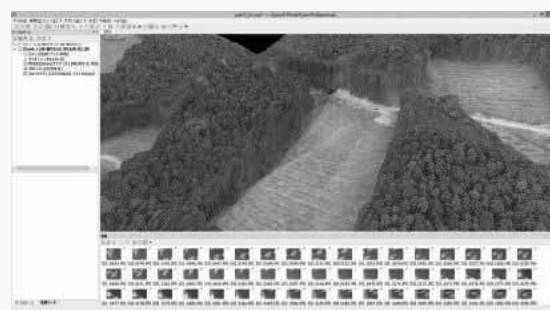
ドローンの空撮データから作成した3次元画像
