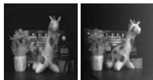
新開発カメラ画像 非冷却 高感度CCDカメラ画像 -20℃に冷却
